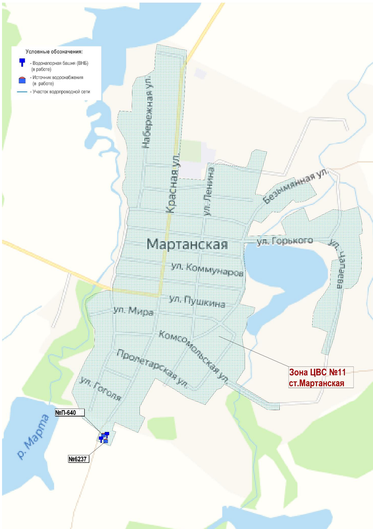
Рис. 1.10. Зоны централизованного водоснабжения ст.Мартанская Суздальского сельского округа
