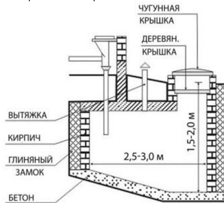
Рис. 1.11. Схема устройства выгребной ямы из бетона
